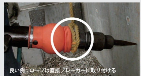
ジャバラ部分を伸縮させてロープを取り付け楽々作業
