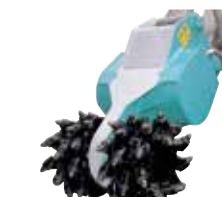
アスファルト・コンクリート切削機
