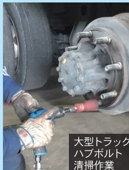
大型トラック ハブナット清掃作業
