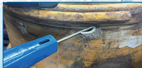
ORタイヤホイールのリング・Oリング 装着溝の清掃作業に。(先端チゼル使用)
