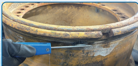
ORタイヤホイールのリング・Oリング 装着溝の清掃作業に。(ブラシ使用)
