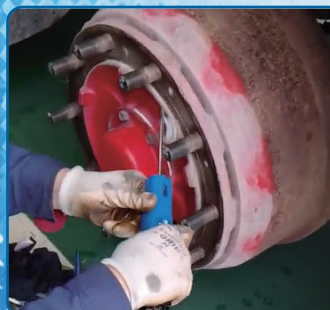
ハブ・ インロー部の 清掃作業 (ブラシ使用)
