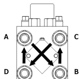
・油圧ホース取り付け部からオイルが滲んでいる場合は、締めすぎによるホース・アダプタの破損を避けるため、必ず一度緩めた後に、規定トルクで締め付けてください。
