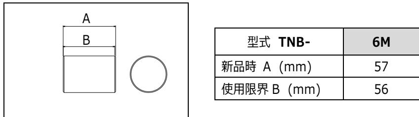
※各部品とも破損時は寸法にかかわらず交換してください。
