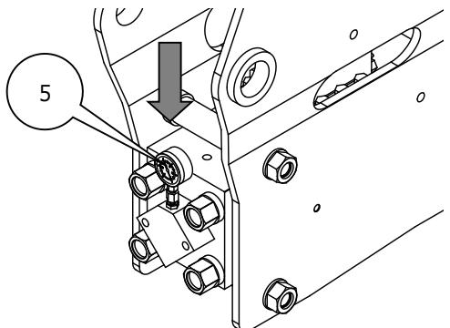
10. ガスバルブプラグ(6)を取り付け、規定の締め付けトルクで締めてください。
