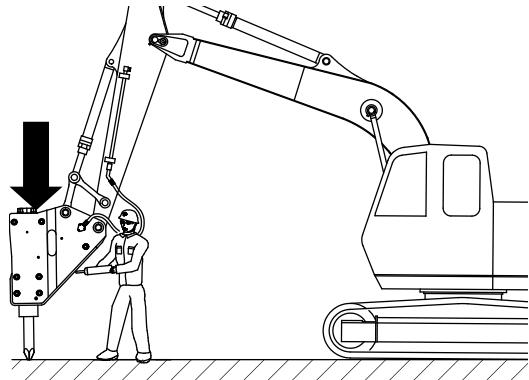
2. 油圧ブレーカを地面に接地させ、アーム先端のストップバルブ(A)に手の届く状態にしてください。
