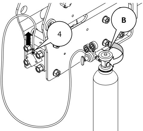
8. ガスバルブに、窒素ガス圧測定用の圧力計(5)を差し込んで、窒素ガス圧を確認してください。
