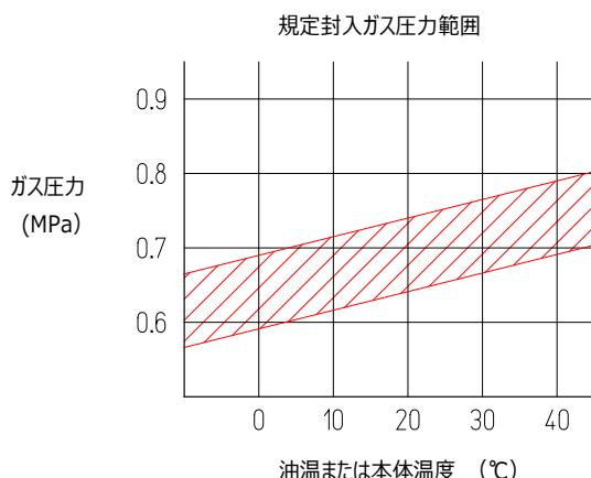
**油温/本体温度 40°Cでの窒素ガス封入圧力**
