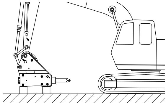
8. 油圧ショベルを操作し、平らな地盤の固い場所を選び、支持台または端太角等を敷いた上に、ブレーカを下ろします。この時、転倒しないように注意してください。
