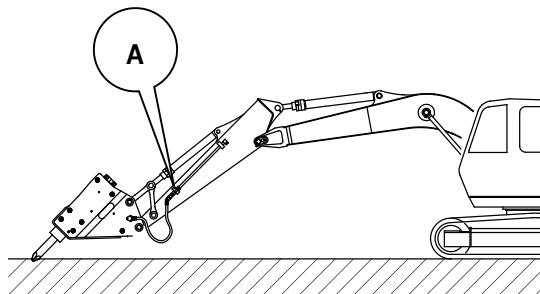
3. 油圧ショベルのエンジンを止めて油圧ブレーカ配管内の残圧を抜いてください。
